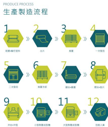
圖二、發泡材料生產流程圖
